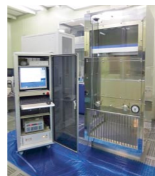
排気用HEPAフィルタユニットに装着した『SR-E』とコンソール部
