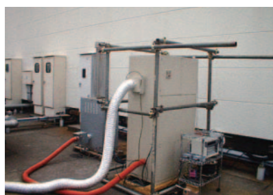
排気のVOC除去試験
