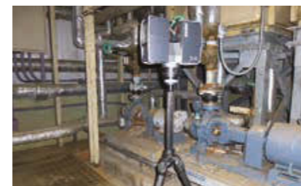
3Dスキャナによる計測風景
