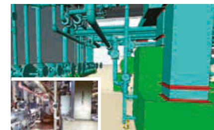
点群データ(左下)と3D-CADデータ
