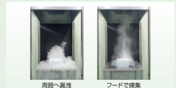
図2 排気補助装置の運転前①と運転後②(水蒸気ミストによる可視化画像)
