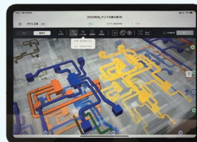
【図2】施工管理ソフト上（ワンタップで進捗登録（黄色が完了範囲））
