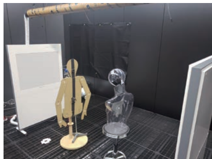
自作の咳マシンを用いた感染症対策技術の評価
